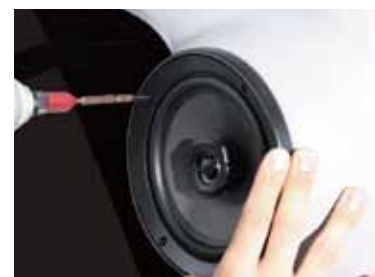
リングの上から付属のタッピングビスで固定する。
