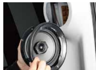
スピーカーにリングを被せる。
