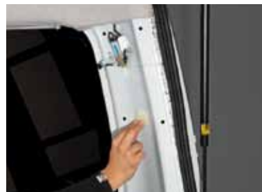
付属のプライマー（下処理清浄シート）で貼付面を清浄します。
