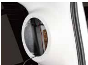
スピーカーケーブルをDピラーカバーの中を通して外側に引き出します。
