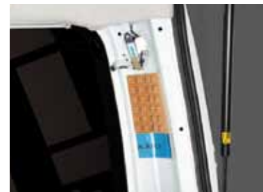
レアルシルトの上に横2列並べて貼り付けます。 ※貼る前に曲面に合わせてデフュージョンを馴染ませてください。
