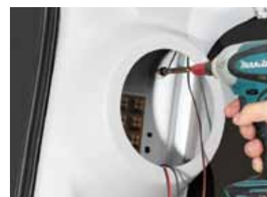
付属のタッピングビスを使って固定します。
