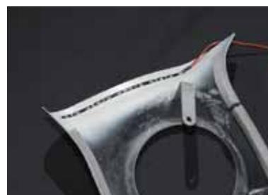
LEDテープに光方向性がありますので、好みに左右揃えて下さい。 テープ貼り付けの際は必ず付属プライマーを使用して下さい。
