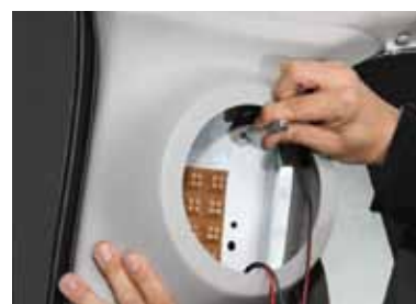
Dピラーカバーを仮止めし、固定穴の位置をポンチします。
