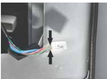
付属のエレタップを使い、LEDテープ接続ケーブルの赤を車両側の緑色（銀の縞）の線に、黒を車両側の黒のライン入りの白（銀の縞）線に接続します。
