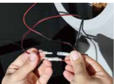
LEDテープ接続ケーブルとLEDテープを接続します。
