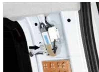
取り外したボルトはDピラーカバーの固定に使用します。
