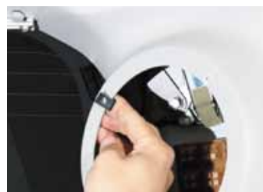
付属のスピードナットをスピーカー固定穴にセットする。
